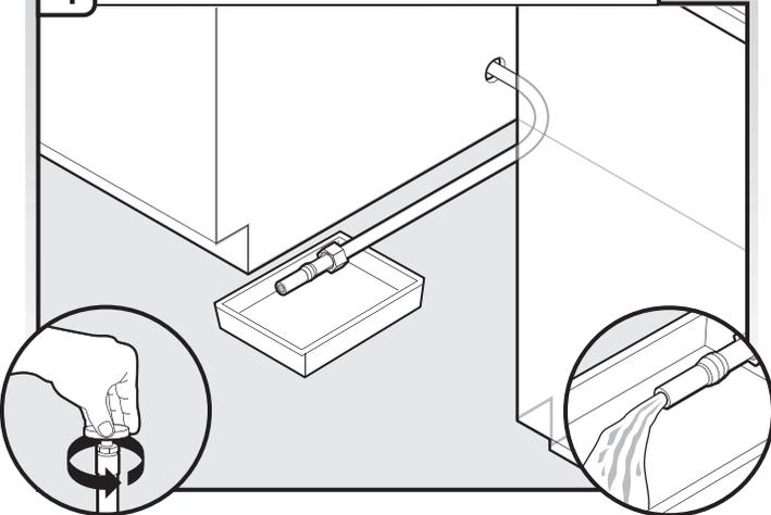
Ouvrir lentement le robinet d'arrêt. Laisser l'eau s'écouler dans un bac de récupération pour l'élimination de toutes les particules solides qui pourraient obstruer l'électrovanne d'admission d'eau. Refermer le robinet d'arrêt.
